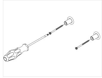
4. Monter la barre d'appui mural sur le support de montage.
