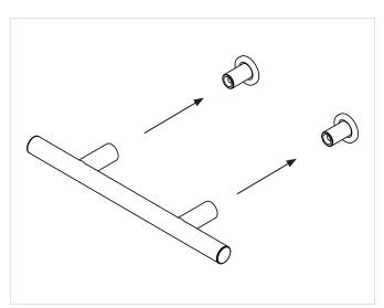
5. Fixer la barre d'appui murale au support de montage à l'aide des quatre vis M4X8.
