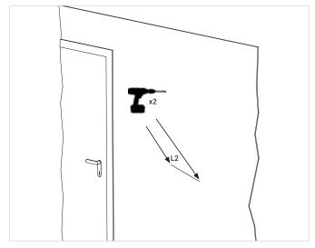
3. Les supports de montage sont fixés au mur à l'aide de vis et de chevilles adaptées à l'environnement d'installation.
